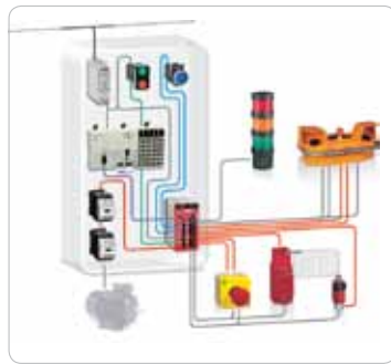
Obr. 1 Riešenie bezpečnostného reťazca – monitorovanie bezpečnostných komponentov PL e, SIL 3
