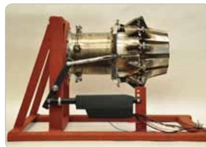
Obr. 3 Výstupná dýza s meniteľnou geometriou pre motor MPM-20
