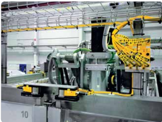
Obr. 2 Konfigurovateľný riadiaci systém PNOZmulti Mini, digitálne vstupné moduly PDP67 a bezpečnostný systém dverí PSEnlock sú základnými súčasťami integrovaného a jasne štruktúrovaného bezpečnostného riešenia.
